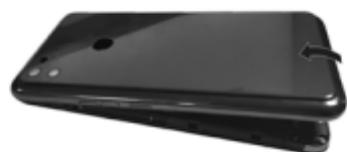
Mit dem Fingernagel an der linken unteren Ecke in die Kerbe greifen und die hintere Abdeckung nach oben ziehen.
