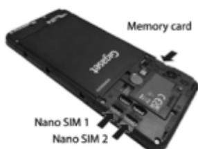
Die Nano-SIM-Karte(n) und Speicherkarte in das vorgesehene Fach schieben. Wenden Sie beim Einlegen der SIM- und Speicherkarte keine Kraft auf – der Anschluss am Telefon und andere Teile könnten beschädigt werden.
